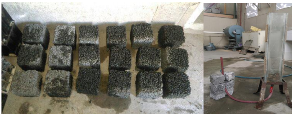
شکل ۴. دستگاه ضریب نفوذپذیری (سمت راست) و نمونه‌های بتن متخلخل ساخته شده جهت انجام آزمایش مقاومت فشاری (سمت چپ)
