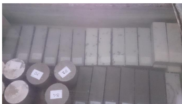
شکل ۳. عمل‌آوری نمونه‌های بتنی در حمام آب
