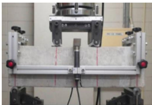
شکل ۵. نحوه تنظیم دستگاه و نمونه جهت آزمایش های میانگین مقاومت باقیمانده
