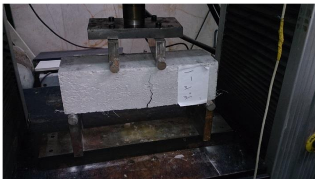
شکل ۴. نحوه تنظیم دستگاه UTM و نمونه بتنی
